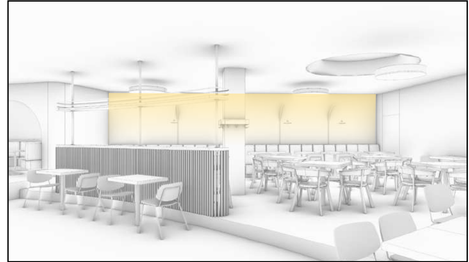
leesbaarheid van veraf door verticale verlichtingssterkte. render: studio aissinger + lighting Studio De Schutter
