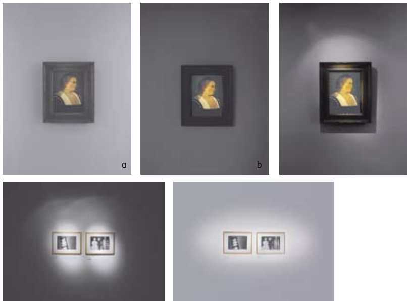
Fig. 6.6 Effect van verschillende bundelbreedten bij het aanlichten van objecten:
