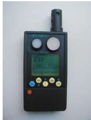
Fig. 10.3 Voorbeeld van gecombineerde handmeter voor verlichtingssterkte, UV-gehalte, temperatuur en relatieve luchtvochtigheid, de vier grootheden die musea willen meten (Elssec 764)
