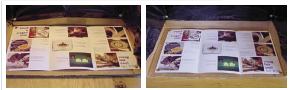
Fig. 4.6 Onder verschillende lichtbronnen kunnen voorwerpen verschillende kleuren hebben; links gloeilamp (Ra=100), rechts compacte fluorescentielamp (spaarlamp) (Ra=85)
