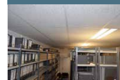
figuur 8 : in dit archief is geen rekening gehouden met de positie van de rekken ten opzichte van de verlichting.
